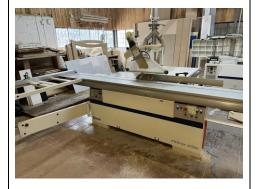
Un combiné toupie tenonneuse avec chariot long, une table rallongée et un entraineur SCM Type Minimax type ST 5ES avec deux lames mélaminées, deux lames à bois, deux lames adélie et une lame diamant
